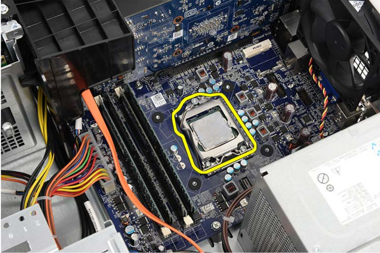
8. İşlemciyi kaldırıp soketten çıkarın ve statik koruyucu bir ambalaja yerleştirin.
